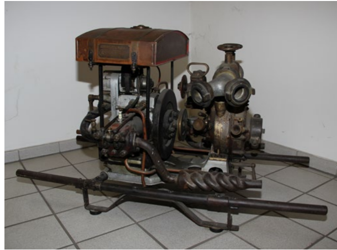
1. Tragkraftspritze Rosenbauer H50/3, Bj. 1928 (Abb. 3.10, Seite 37)
