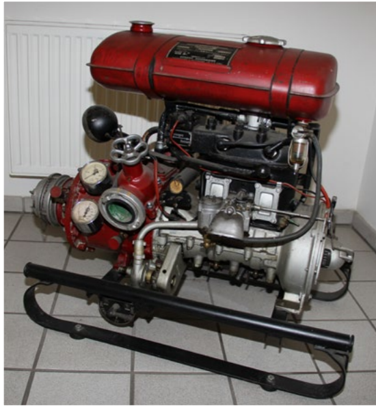
Abb. 6.5: 1955 in Dienst gestellte Motorspritze (Fabrikat Rosenbauer, Typ R75), welche heute noch als Museumsstück im Rüsthaus steht
