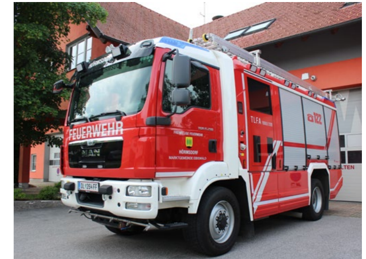
10. Tanklöschfahrzeug mit Allradantrieb und 1.600 l Löschwasser – TLFA 1000: Man TGM 15.290, Baujahr 2014, Indienststellung 2015 (Abb. 0.2, Seite 182)
