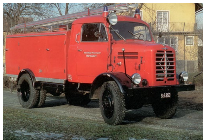
5. Tanklöschfahrzeug mit 2.000 l Löschwasser – TLF 2000: Borgward B522 AO, Baujahr 1962, Ankauf und Indienststellung 1980 (Abb. 8.2, Seite 110)
