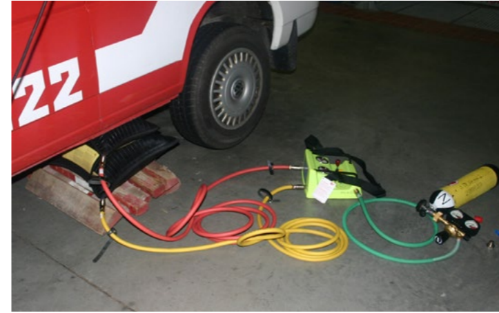
Abb. 10.28: Mit den Hebekissen konnte man auch ein neues technisches Gerät in Dienst stellen, welches zum Heben von Lasten bis zu 18 t, vorwiegend zum Befreien eingeklemmter Personen, geeignet ist
