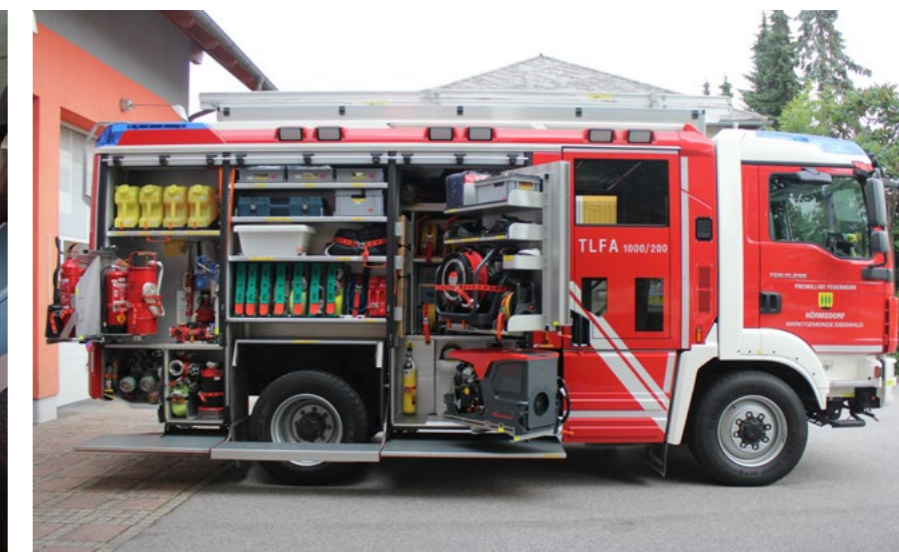
Abb. 11.35 bis 11.38: Das neue Fahrzeug führt alles mit, was die ersteintreffende Löschgruppe zur Hilfeleistung fast jeder Art benötigt
