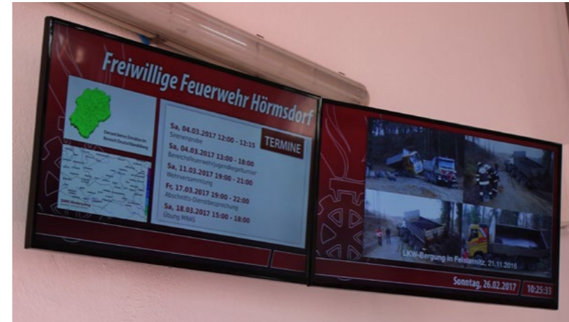
Abb. 11.62: Die Einsatzmonitore zeigen im Alarmfall wichtige Informationen für die einrückenden Feuerwehrleute an, die so sofort einen Überblick haben
