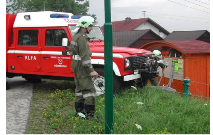
Abb. 10.29: Die Frontseilwinde erweiterte die technische Ausrüstung und erleichterte ab sofort Fahrzeugbergungen, wie hier am Bild bei der ersten Einsatzübung
