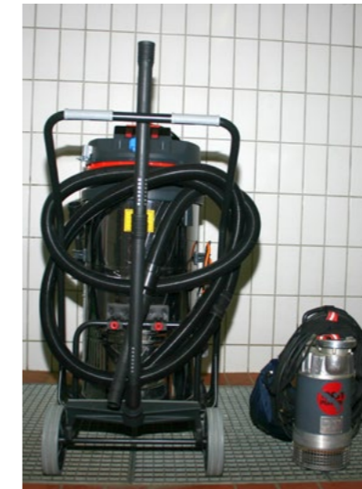
Abb. 10.66: 2010 wurden ein Nasssauger und eine zweite Tauchpumpe angekauft, um für Auspumparbeiten besser gerüstet zu sein
