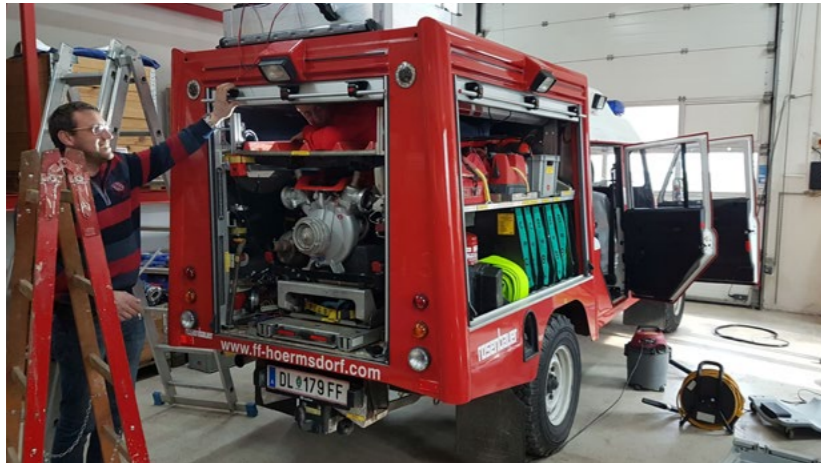
Abb. 11.88: Das Kleinlöschfahrzeug wurde mit einem Schwimmsauger für Brandeinsätze und einer Verkehrsleiteinrichtung für Einsätze auf Verkehrsflächen nachgerüstet
