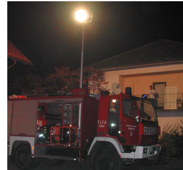
Abb. 10.30: Im Zuge des Austauschs des Kleinlöschfahrzeuges wurde das Tanklöschfahrzeug mit einem Lichtmast nachgerüstet
