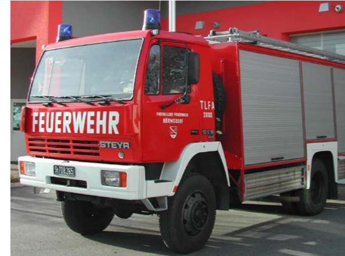
7. Tanklöschfahrzeug mit Allradantrieb mit 2.000 l Löschwasser – TLFA 2000: Steyr 10S18, Baujahr 1987 (Abb. 8.51, Seite 123)
